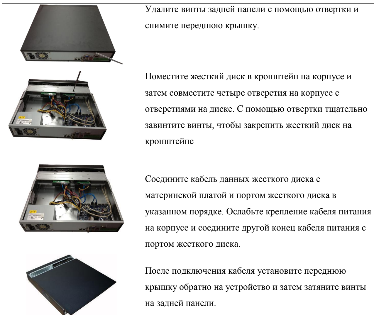
Рисунок 5.1-Установка жестких дисков
